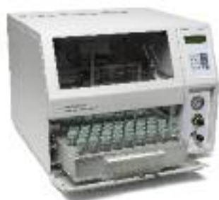
Inyector automático de purga y trampa Agilent ARCHON con bandeja extraíble
