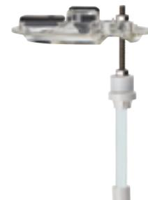
Float-A-Lyzer con soporte y cubierta de evaporación
