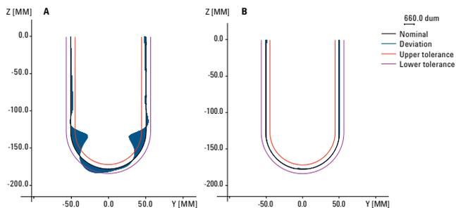
Variación de la forma del vaso entre los vasos estándar probados por Agilent (A) y los vasos moldeados VF de Agilent (B), que mejoran las tolerancias especificadas en la USP para los vasos. La línea central (de las tres líneas que aparecen) indica la forma ideal del cilindro y el hemisferio. Las dos líneas dibujadas a ambos lados representan la tolerancia de  $\pm 0,3$  mm respecto a la línea central.
