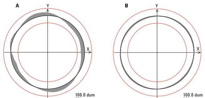
Variación de la redondez entre un vaso estándar (A) y un vaso moldeado VF de Agilent (B). La línea central (de las tres líneas que aparecen) indica la forma ideal del cilindro y el hemisferio. Las dos líneas dibujadas a ambos lados representan la tolerancia de  $\pm 0,3$  mm respecto a la línea central.
