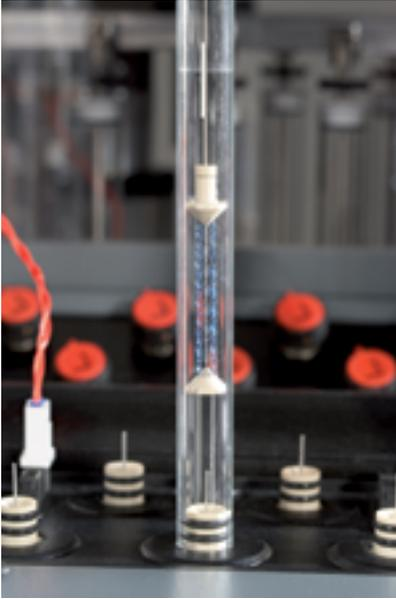
Celda de muestra para instrumentos 400-DS con soporte de prótesis vasculares
