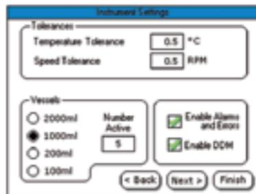
Los parámetros y funciones específicos del firmware del instrumento de disolución 708-DS, como las tolerancias, los volúmenes de los vasos y las alarmas, pueden ajustarse con facilidad para adaptarlos a las necesidades concretas de su laboratorio.
