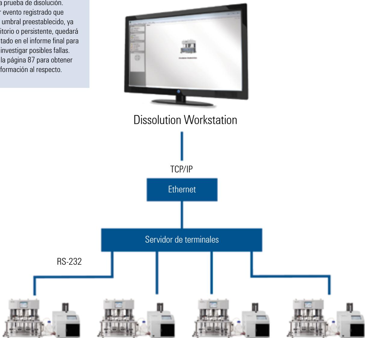
El software Dissolution Workstation permite controlar hasta 4 sistemas desde una única PC. Además, cada PC de una red común puede conectarse con una base de datos centralizada.
