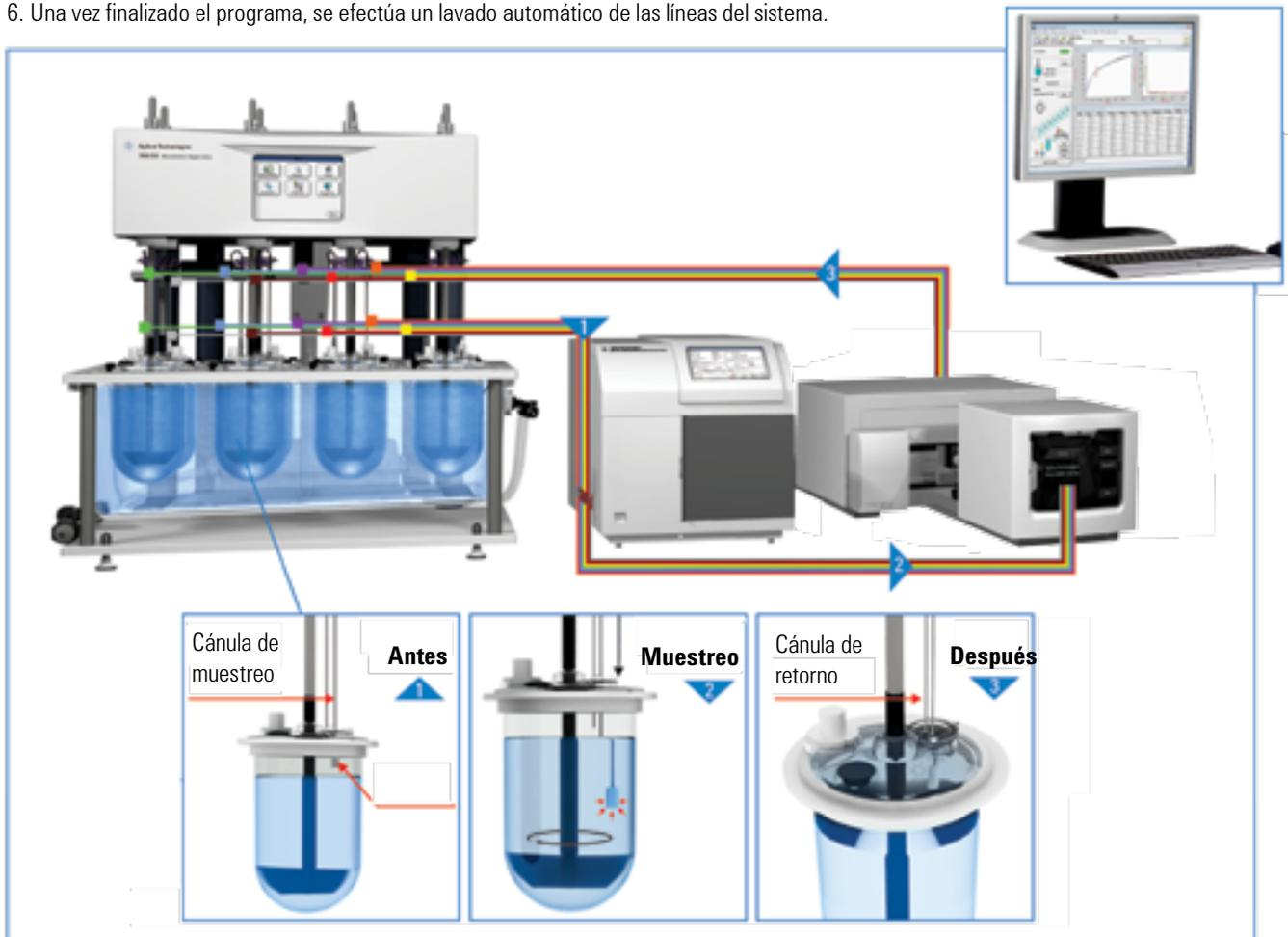
Sistema de disolución Cary 8454: configuración de instrumento único con estación de muestreo para disolución 850-DS
