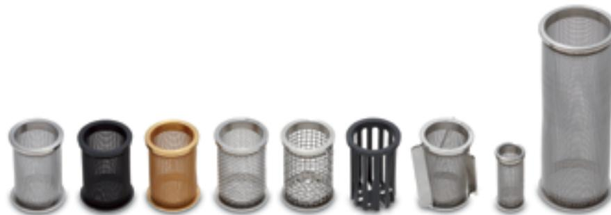
De izquierda a derecha: canastilla de malla 40, canastilla recubierta de PTFE, canastilla recubierta de oro, canastilla de malla 20, canastilla de malla 10, canastilla para supositorios, canastilla con 3 aletas, minicanastilla y canastilla para bolos
