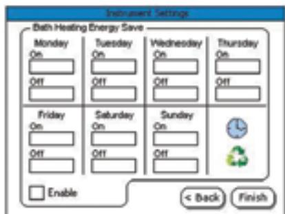
Control del calentador/circulador mediante la programación de ciclos de encendido/apagado para mejorar la eficiencia energética.
