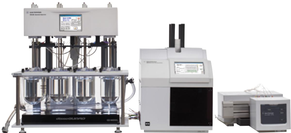
Instrumento 708-DS con estación 850-DS y espectrofotómetro UV-visible Cary 8454
