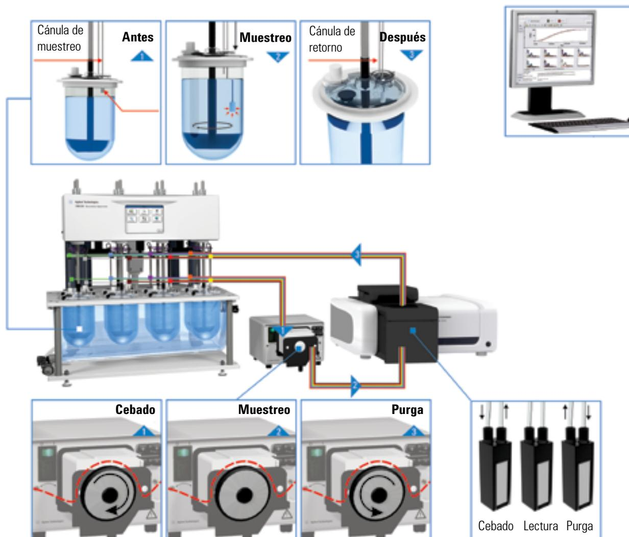
Sistema de disolución UV Cary 60: configuración de instrumento único con bomba peristáltica
