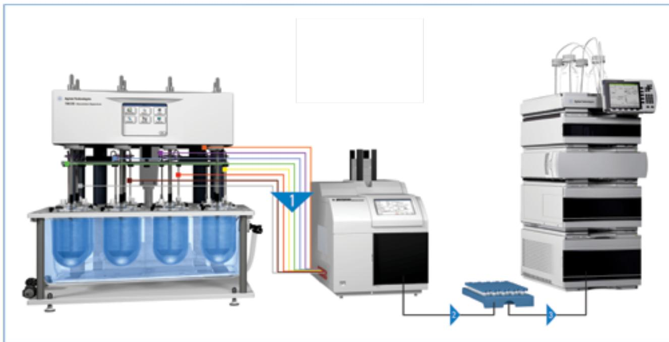
Las muestras recogidas por la estación 850-DS y depositadas en una bandeja para muestras HPLC de Agilent pueden colocarse directamente en el muestreador automático del sistema HPLC, lo que evita tener que transferir manualmente los viales individuales a una bandeja independiente.
