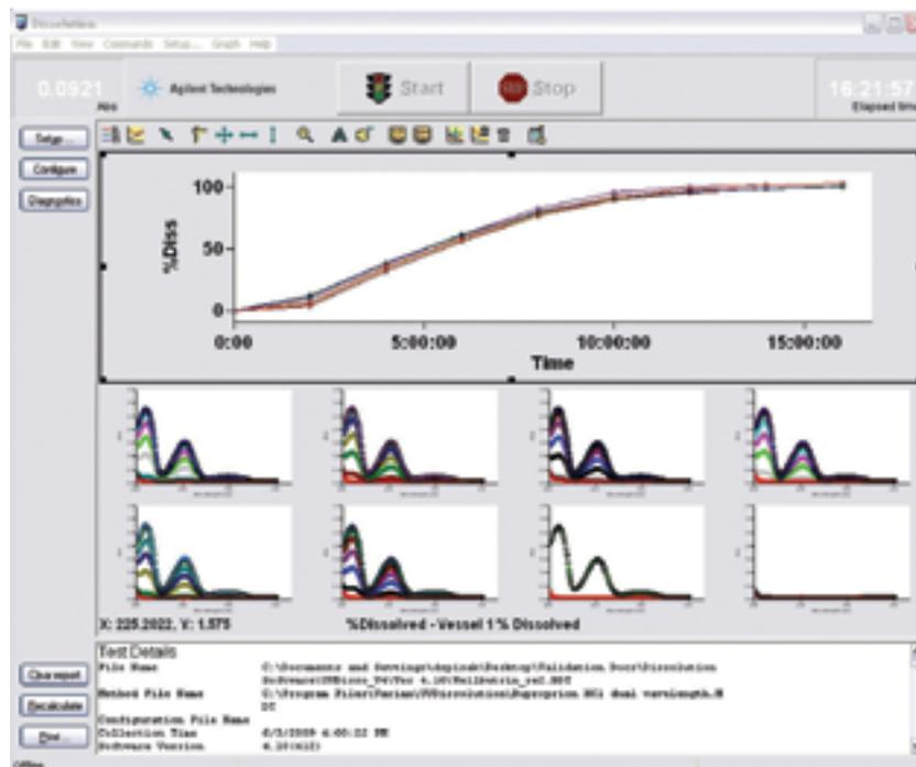
Progreso de un perfil de disolución UV a medida que se adquieren datos
