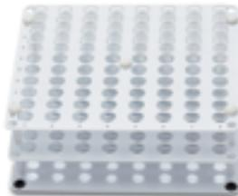
Bandejas de muestra con viales HPLC con tapón y sellados con séptum (parte superior) y tubos de vidrio (parte inferior)
