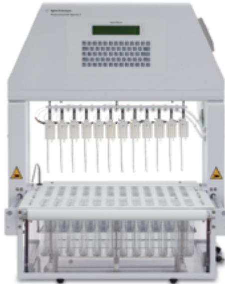
Soporte de movimiento alternativo para instrumentos USP Aparato 7 (50 ml)
