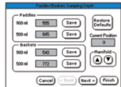
La capacidad de especificar la profundidad exacta del colector hace que cada muestra pueda tomarse en la misma ubicación del vaso de disolución conforme a los requisitos de la USP. Esto mejora la reproducibilidad y la uniformidad para cada prueba que se realice, un aspecto crítico para los tests de disolución.
