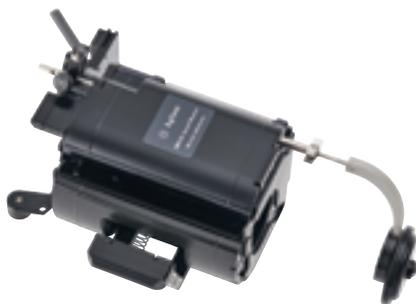
Sistema MQS 280-DS con extensión de brazo modificada y compatible con diversos tipos de vasos de disolución.
