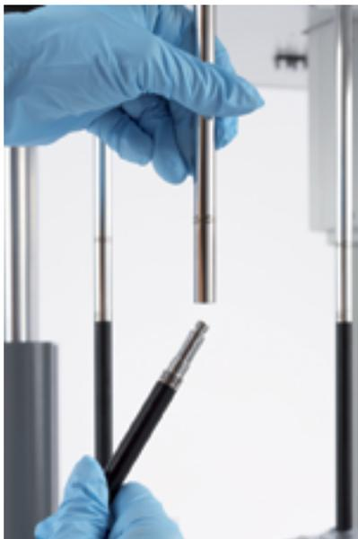
Eje receptor superior y paleta intercambiable inferior
