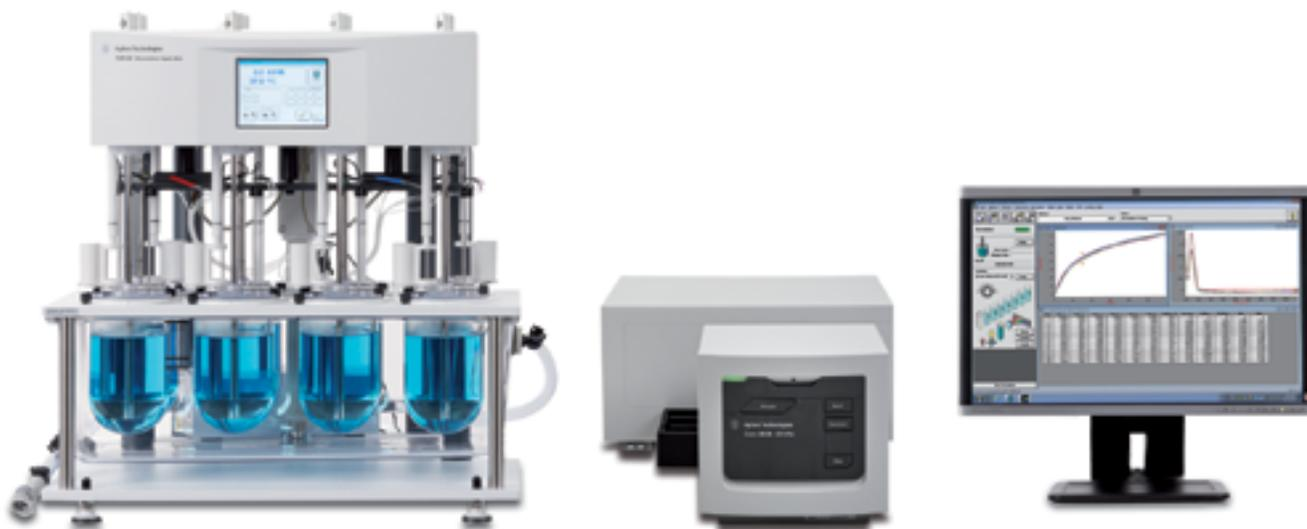
El instrumento 708-DS y la estación 850-DS, combinados con el espectrofotómetro Cary 8454, forman un sistema UV en línea controlado por el software ChemStation UV-Vis
