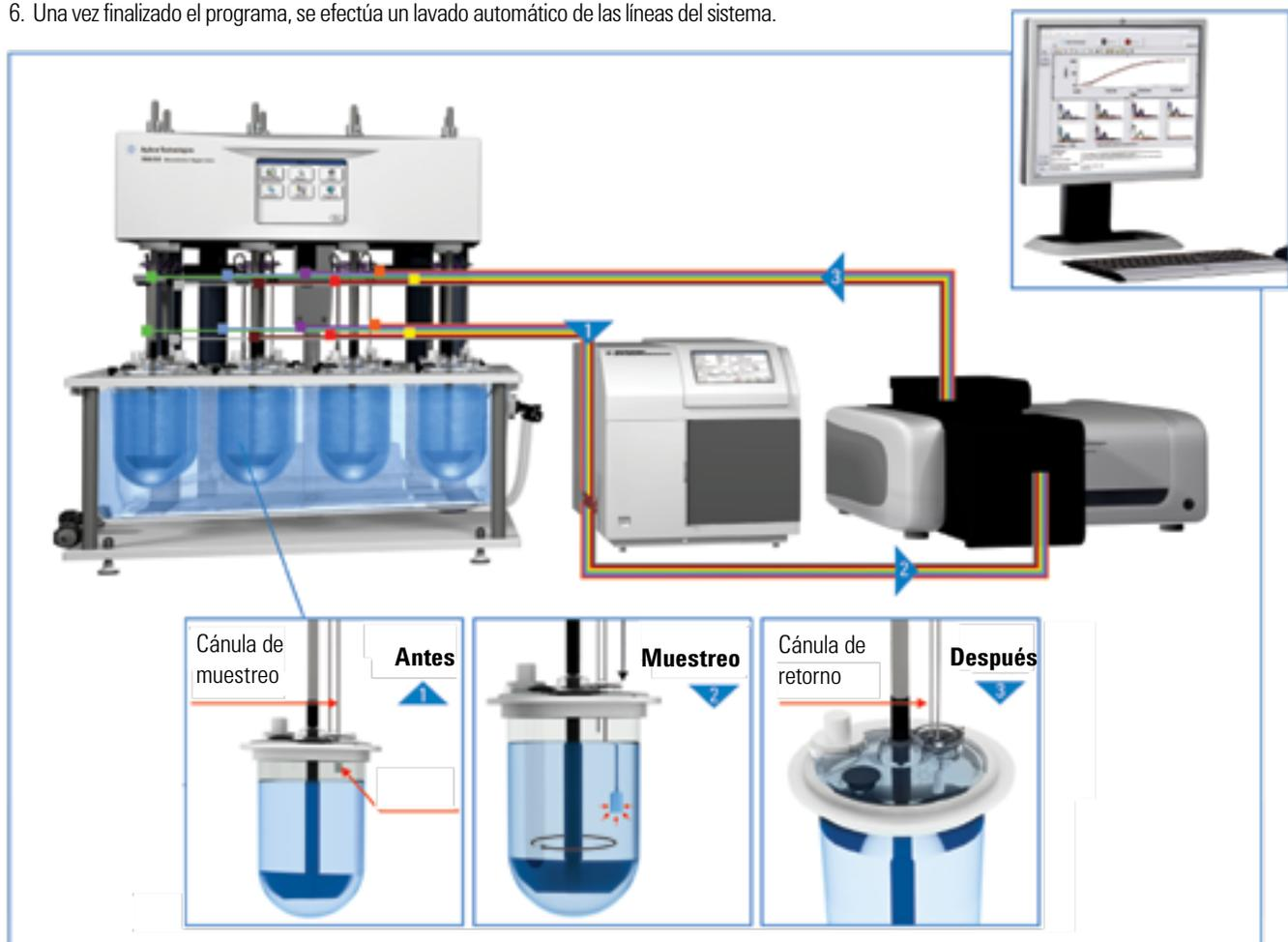
Sistema de disolución UV Cary 60: configuración de instrumento único con estación de muestreo para disolución 850-DS
