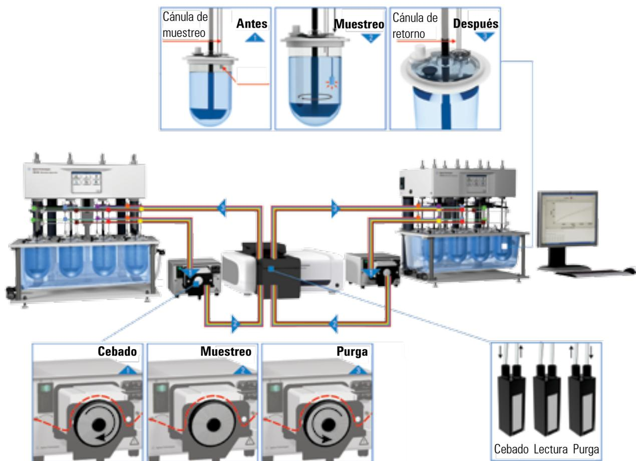
Sistema de disolución UV Cary 60: configuración de instrumento doble con bombas peristálticas
