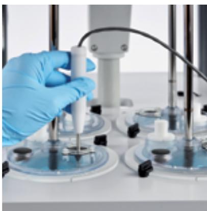
Medida manual de la temperatura con la sonda de temperatura 708-DS
