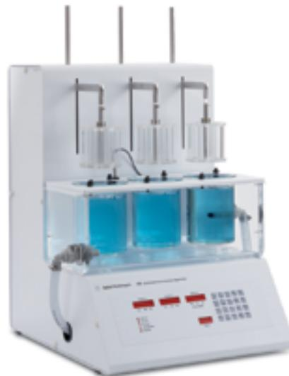
Sistema automatizado de pruebas de disgregación Agilent 100
