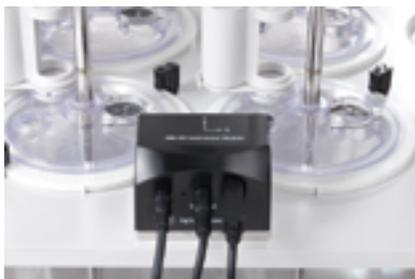
Combinado con el software Dissolution Workstation, el módulo de instrumento 280-DS aporta información valiosa sobre las condiciones ambientales de prueba en tiempo real.
