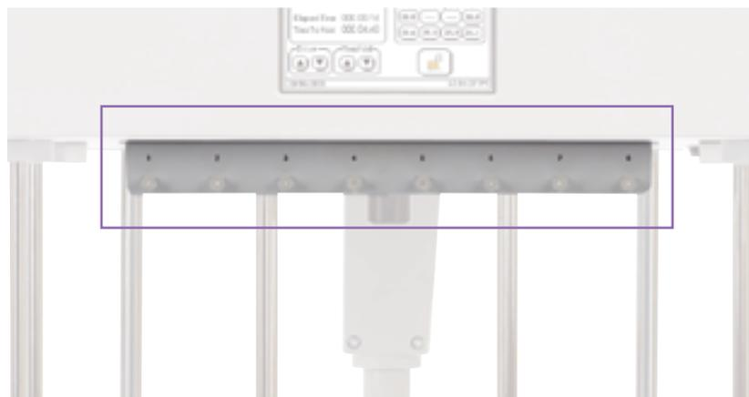
Soporte para muestreo manual montado en el instrumento 708-DS
