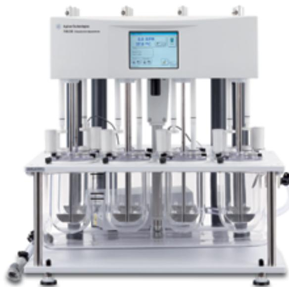
El instrumento 708-DS puede configurarse con facilidad para instrumentos USP Aparato 1, 2, 5 y 6, así como para instrumentos para pruebas de disolución intrínseca o celdas amplificadoras (de inmersión).
