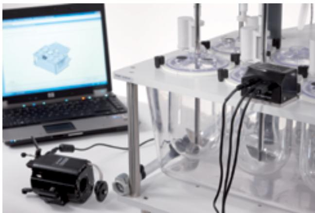
Puede tomar medidas de parámetros físicos del instrumento de disolución 708-DS usando el sistema de calificación mecánica 280-DS. Consulte las páginas 86, 87 para obtener más información sobre el sistema 280-DS.
